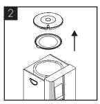
Enlever le couvercle en polystyrène. Soulever délicatement le couvercle en plastique du réservoir, en prenant soin de ne pas déconnecter les tuyaux.
