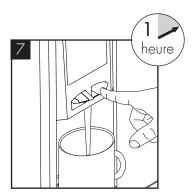
Allouer jusqu'à 1 heure pour permettre à l'eau d'atteindre la température minimum prédéfinie.
