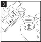
Ne pas oublier le plateau d'égouttement. Si un système de gestion du trop-plein est installé, le vider et le rincer avec une petite quantité de liquide de nettoyage, si nécessaire.
