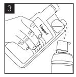
Ajouter 25 ml de liquide de nettoyage de Bioguard (Bioguard Internal Sanitisation fluid) à une cartouche filtrante vide et propre.
