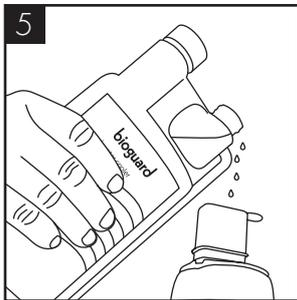
5 Ajouter 25 ml de liquide de nettoyage de Bioguard (Bioguard Internal Sanitisation fluid) à une cartouche filtrante vide et propre.
